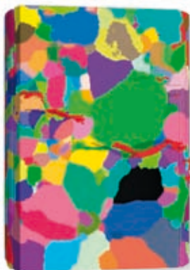
Visualizzazione della progressione di una fessura in una lega di alluminio.
